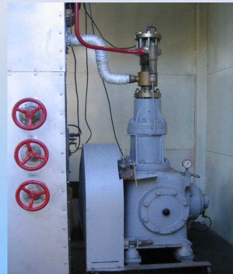
Высокоэффективный, надежный поршневой детандер
